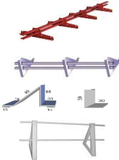
Ограждение кровельное предохраняет от падения с крыши во время проведения работ.
